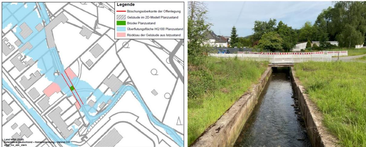
Abbildung 1-1:      Überflutungsfläche HQ100 der Holzbach-Offenlegung und Foto der Offenlegung
