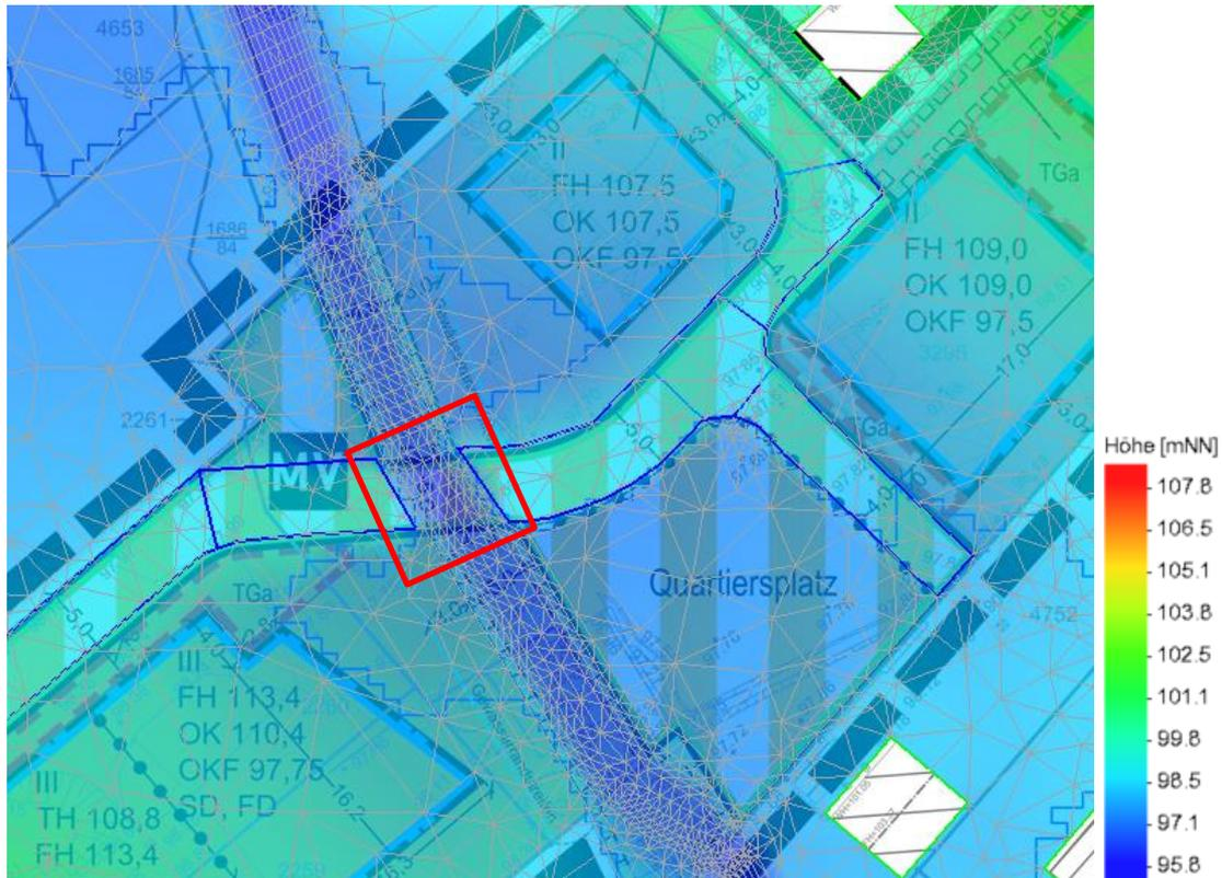
Abbildung 4-5: Ausschnitt 2D-Modell Planzustand 6 mit Bruchkanten (blau) und Netzstruktur (grau) und Lage der geplanten Brücke (rot), farblich abgestuft nach der Geländehöhe
