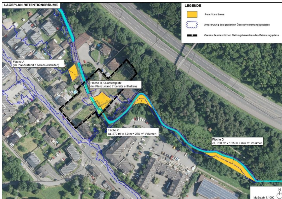
Abbildung 5: Lageplan Retentionsräume (Quelle: Hydrotec)
