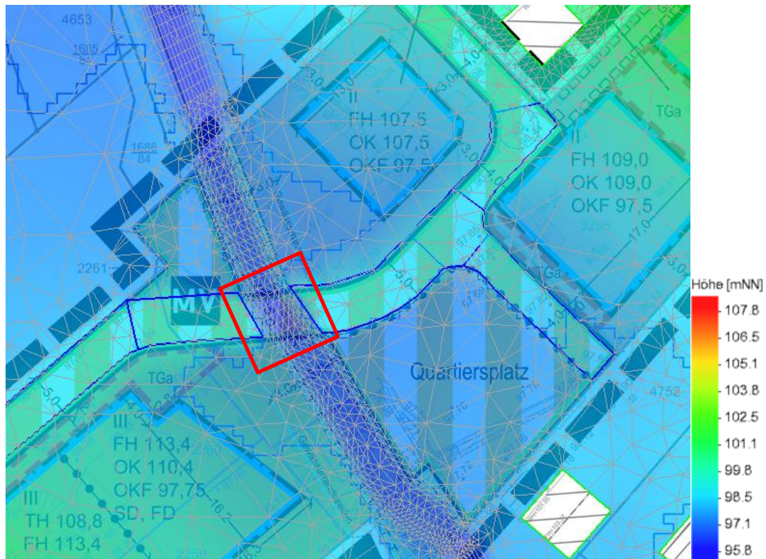
Abbildung 4-5: Ausschnitt 2D-Modell Planzustand 6 mit Bruchkanten (blau) und Netzstruktur (grau) und Lage der geplanten Brücke (rot), farblich abgestuft nach der Geländehöhe
