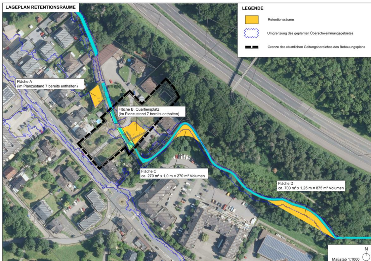
Abbildung 7-2: Retentionsflächen und dazugehörige Volumina zum Ausgleich des Retentionsvolumenverlusts (H+B Stadtplanung 2025b)
